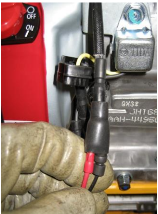
2 CONECTE O CABO VERMELHO COM OS CABOS DO MOTOR
