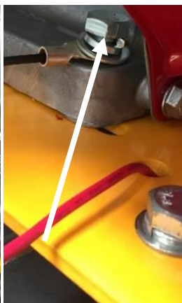
3 RACCORDER LA MISE À LA TERRE À LA VIS DU MOTEUR
