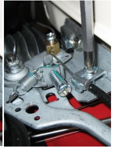
4 FIJAR LA FUNDA DEL ACELERADOR
