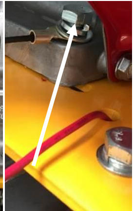
3 CONECTAR LA TOMA TIERRA AL TORNILLO DEL MOTOR
