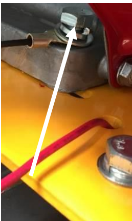
3 CONECTE O ATERRAMENTO AO PARAFUSO DO MOTOR
